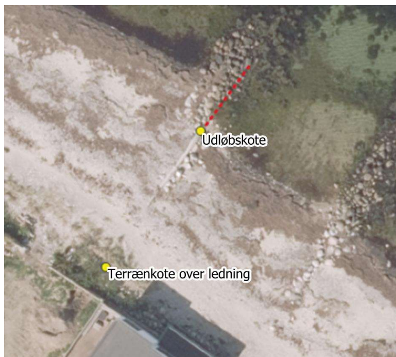
Figur 6-60: Opmålingspunkter ved udløb af Kongens Mølle Øst. Stiplede rød linje markerer længden af rørforlængelsen.
