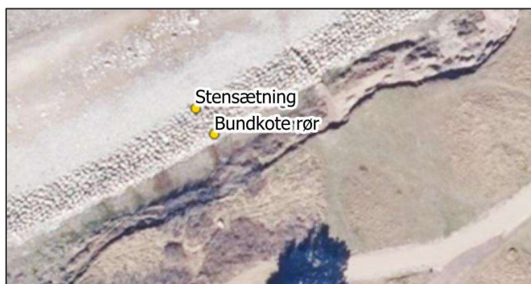
Figur 6-32: Opmålingspunkter ved udløb af Gribskov 2.
