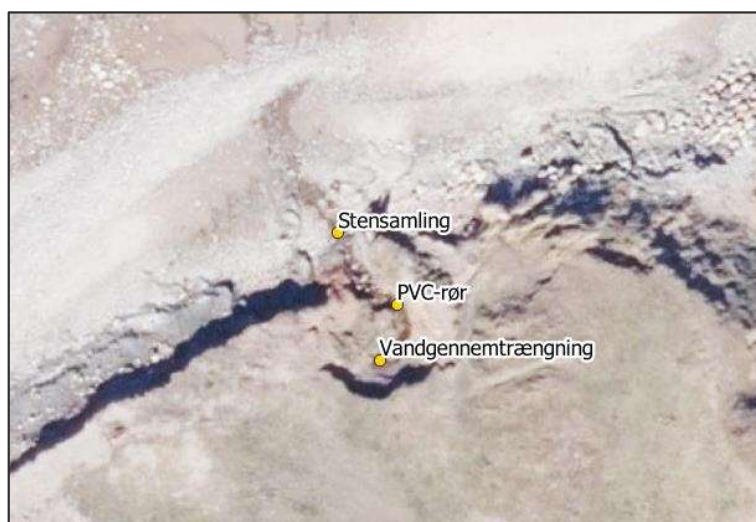
Figur 6-29: Opmålingspunkter ved udløb af Gribskov 1.
