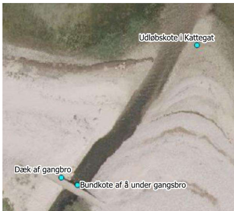
Figur 6-35: Opmålingspunkter ved udløb af Esum Å.
