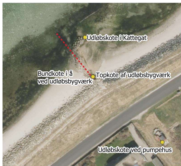
Figur 6-9: Opmålingspunkter ved udløb af Nødebohuse Pumpekanal.
