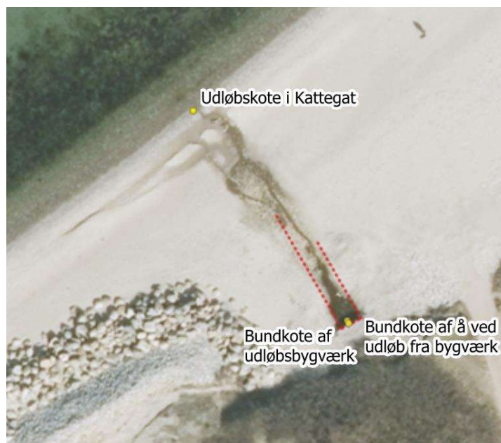
Figur 6-12: Opmålingspunkter ved udløb af Maglemosegrøften. Stiplede rød linje markerer længden af ledeværket.
